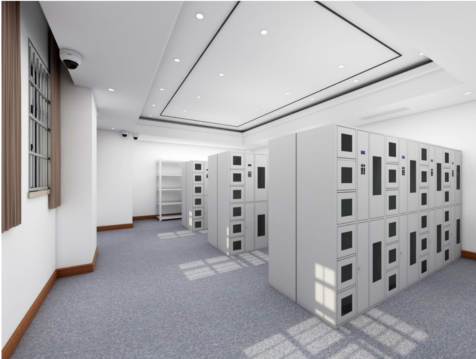
G. 大型物品保管区：部署智能密集柜 8 组*8 列，共计 64 组，单组规格宽 1000mm*深 600mm*高 2500mm，共计 96 立方米。智能密集柜通过涉案财物管理系统进行控制开启、关闭、通风等操作。
